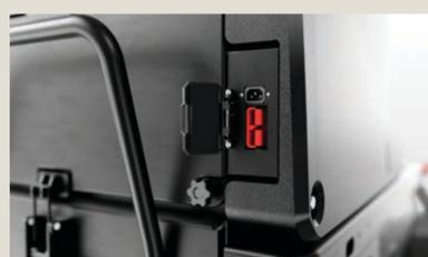
Chargez la machine à l'aide de la prise de charge arrière. Il y a deux connexions, une pour le chargeur externe et une pour le chargeur embarqué s'il est installé.
