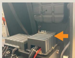
3. Ouvrez le capot de la machine et vérifiez les fusibles des balais.
