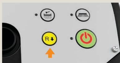
Appuyez sur le bouton marche / arrière pour manoeuvrer la balayeuse vers l'arrière. La machine ne balaie pas en marche arrière.
