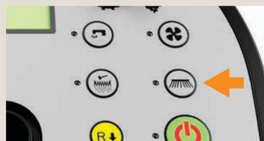
Appuyez sur le bouton du balai latéral pour remonter les balais latéraux et utiliser la machine uniquement avec le balai principal.
