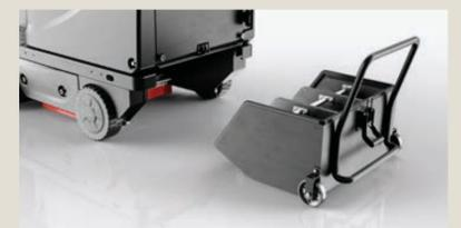
Appuyez sur le bouton OneTouch™ pour arrêter toutes les fonctions. Relâchez lentement le mécanisme de verrouillage de la trémie, car elle peut être lourde. Utilisez la poignée pour retirer et vider la trémie.
