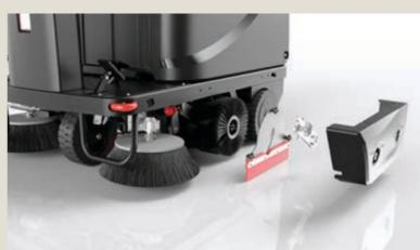
Retirez, nettoyez et inspectez le balai principal et vérifiez les balais latéraux. Nettoyez la machine avec un chiffon humide.
