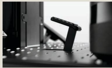
Appuyez sur la pédale pour ouvrir le clapet / flap et balayer les gros débris.
