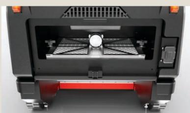
Retirez le panneau du filtre arrière pour vérifier le filtre, réinstallez le panneau et la trémie.
