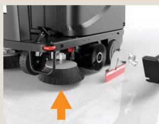
2. Réglage du balai latéral si nécessaire, remplacez le balai latéral si les poils sont usés.
