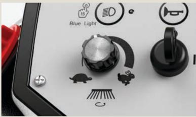
Ajustez la vitesse des balais latéraux en tournant le potentiomètre.
