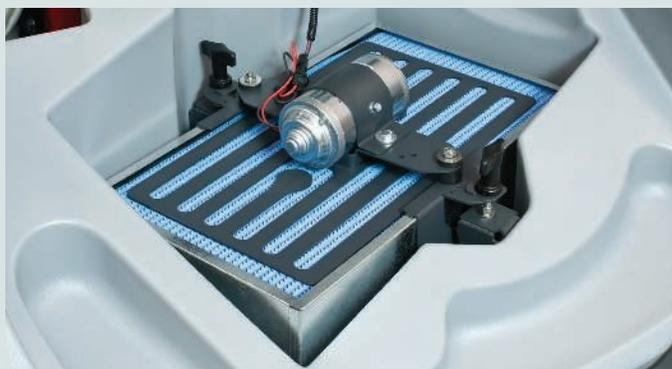
Nanofiltre synthétique Donaldson PowerCore® UltraWeb® à haute capacité avec indice MERV 13 avec un agitateur à fréquence variable. Il fournit une capacité supérieure de maintien de la poussière/saleté dans un boîtier plus compact pour une durée de vie plus longue du filtre et une meilleure maîtrise de la poussière par rapport à filtres à plis classiques
