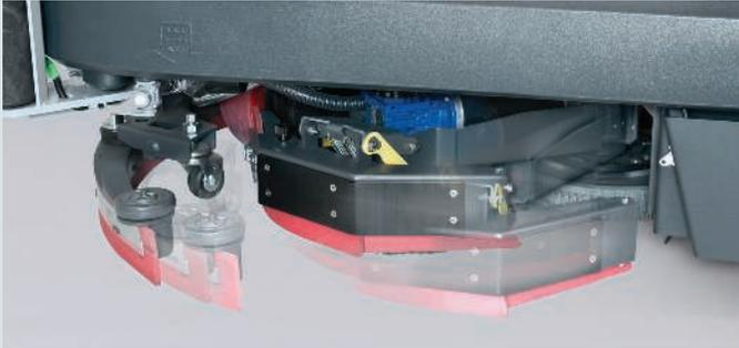
Le plateau de disque décalé rétractable de 4 pouces (10 cm) améliore le frottement des bords et résiste aux dommages causés par un impact accidentel
