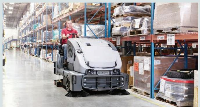
SmartFlow™ ajuste le débit de la solution avec la vitesse de la machine, en utilisant de l'eau et des produits chimiques. Une productivité proportionnellement plus élevée avec moins de cycles de vidage et de remplissage par réservoirs
