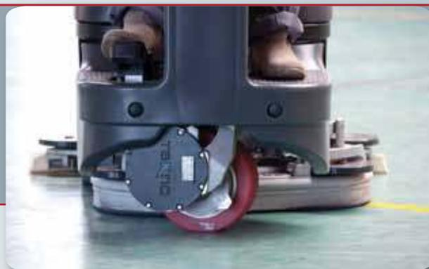
Nouveau système de bloc de lavage (relié au volant) : lorsque vous faites tourner le volant à gauche, le plateau bouge aussi sur la gauche (c'est la même chose du côté opposé) ; cela garantit des performances de nettoyage optimales avec un grand confort et un minimum d'efforts. Le chemin de lavage est complètement couvert par l'embouchure et il est inutile d'utiliser des jupes latérales.
