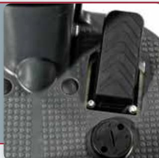
Nouvelle pédale avec système de talon réglable (breveté) pour éliminer toute tension au niveau du pied de l'opérateur
