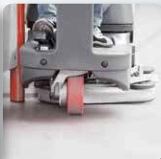
Le bloc de lavage est protégé par de larges galets et rentre à l'intérieur de la machine s'il heurte un obstacle (protection de la machine et de l'environnement).
