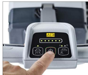
10. Arrêtez la machine en utilisant le bouton principal.
