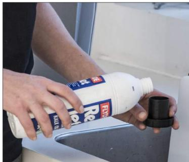
3. Le bouchon du réservoir peut être utilisé pour le dosage du détergent. Un bouchon plein de 30 ml donne 0,5% de détergent pour un réservoir de 6L. (\*)
