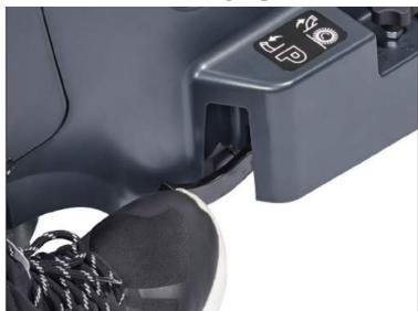
11. Pour le transport et le stockage de la machine, descendez la pédale (soulevez légèrement l'avant de la machine en inclinant la poignée).
