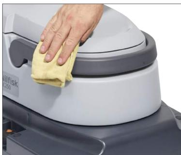
16. Nettoyez la machine à l'aide d'un chiffon humide et, au besoin, utilisez un produit de nettoyage neutre.
