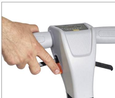
8. Pour les fonctions de balayage, relevez/verrouillez le levier droit pour remonter l'embouchure et permettre de ramasser les petits débris.
