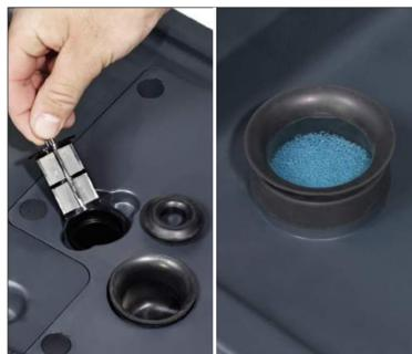
13. Contrôlez et nettoyez le filtre de solution et le filtre d'aspiration.
