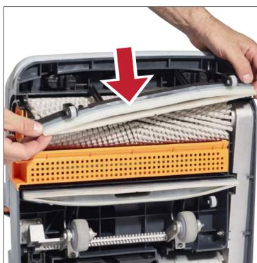
2. Vérifiez si des débris obstruent l'entrée de l'embouchure et si les lamelles ne sont pas usées ou endommagées.
