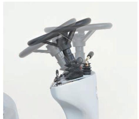
Avec une colonne de direction réglable, et des pédales pour le contrôle directionnel, la balayeuse à conducteur porté offre un fonctionnement ergonomique et sécurisé.
