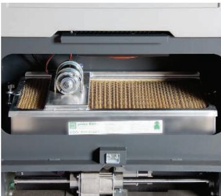
Un filtre à poussière sans outil contient un système de déflecteur pour filtrer les particules plus grandes et prolonger la durée de vie du filtre. Une grande trémie de débris en acier à quatre côtés comprend des roues de transport pour faciliter l'utilisation et la sécurité de
